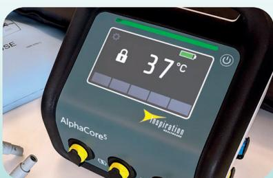
Interface simple à écran tactile avec une plage de température de 25°C à 40°C sélectionnable par l'utilisateur.
